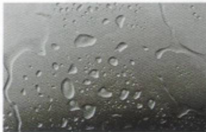
Sofort nach der Beschichtung „bricht“ die Wasserschicht an Deck auf.
